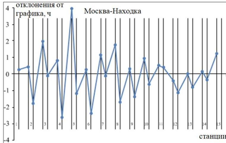
Рисунок 17 - Отклонения от графика движения контейнерных поездов
